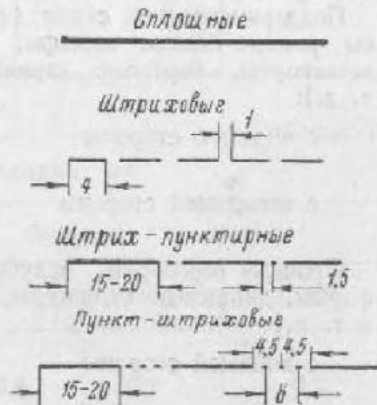
Рис. 48. Типы линий на судостроительных чертежах.
