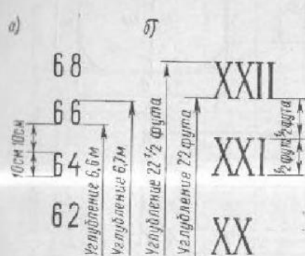
Рис. 5. Марки углубления: а — на правом борту; б — на левом борту.
