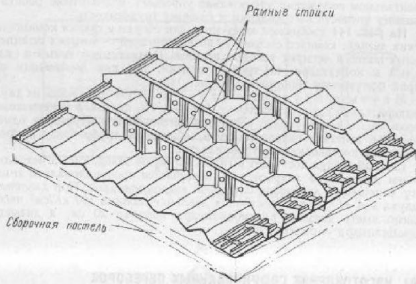
Рис. 147. Продольная гофрированная переборка в сборе.
