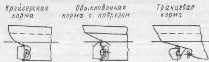
Рис. 27. Типичные формы носовой и кормовой оконечностей корпуса.
